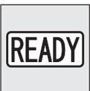
READY 指示燈會持續閃爍至插電型油電複合動力 EV 系統啟動。當插電型油電複合動力 EV 系統正常啟動且車輛行駛就緒時，指示燈會停止閃爍並保持點亮。請參閱 7-14 頁的「啟動插電型油電複合動力 EV 系統」。
