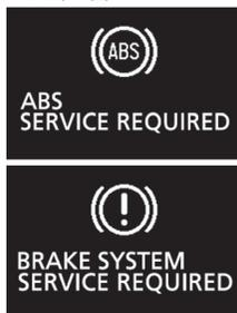
ABS 和煞車力分配功能可能無法作用，所以緊急煞車會使得車輛不穩定。避免重踩煞車與高速行駛。立即將車輛停放至安全位置，並建議您進行車輛檢查。
