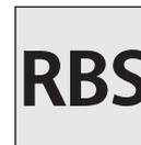
當插電型油電複合動力 EV 系統運作時，若再生煞車無法使用，此警示燈會亮起。
