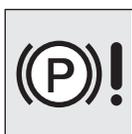
電子駐車煞車系統故障時，此警示燈就會亮起。通常，當電源開關的運作模式切換至 ON 時，此警示燈會亮起，並在數秒後熄滅。
